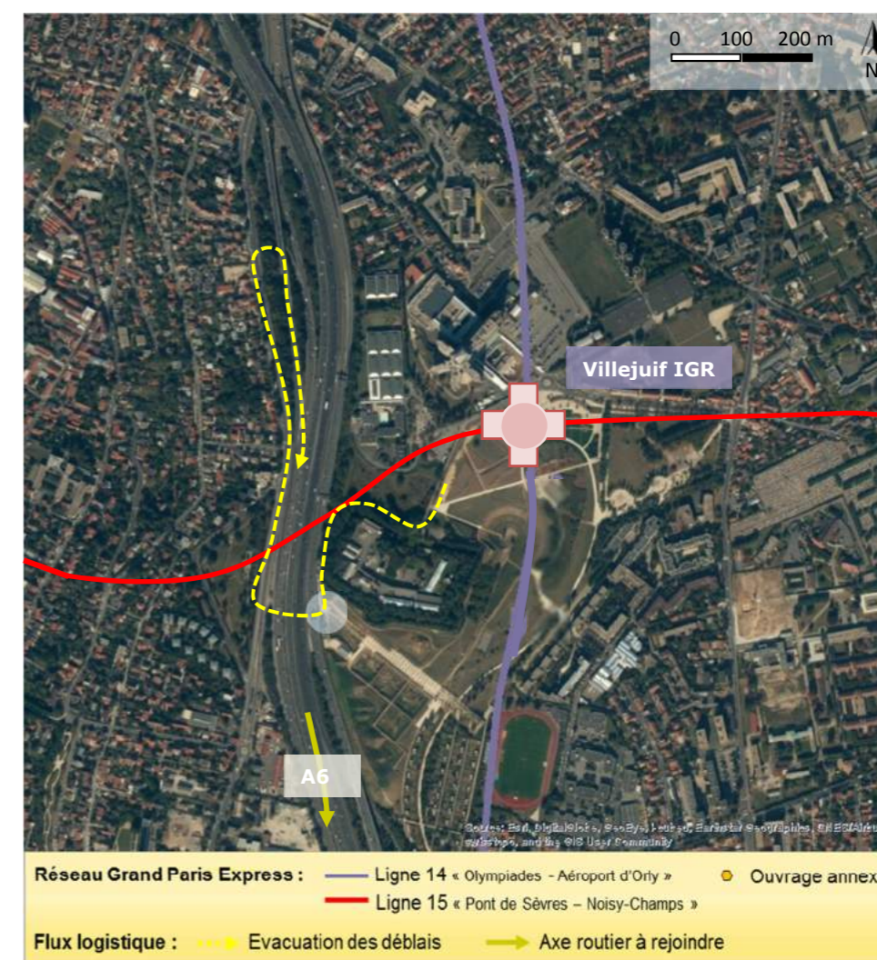
Schéma 3 : Itinéraire de circulation en phase chantier depuis Villejuif IGR
